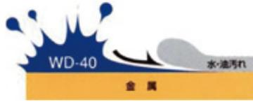
MUP は金属面に付着した水・油汚れを置換・除去し、被膜が塗布面に沿って強力に浸透する「水置換機能」がある。その性能で水分、湿気を取り除き油膜を張って金属表面を保護する。
