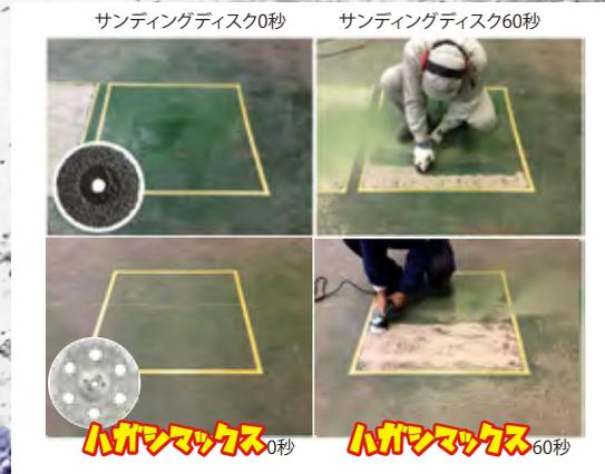
使用用途: 弾性、アクリル系塗膜、吹付けタイル、接着剤剥離など
